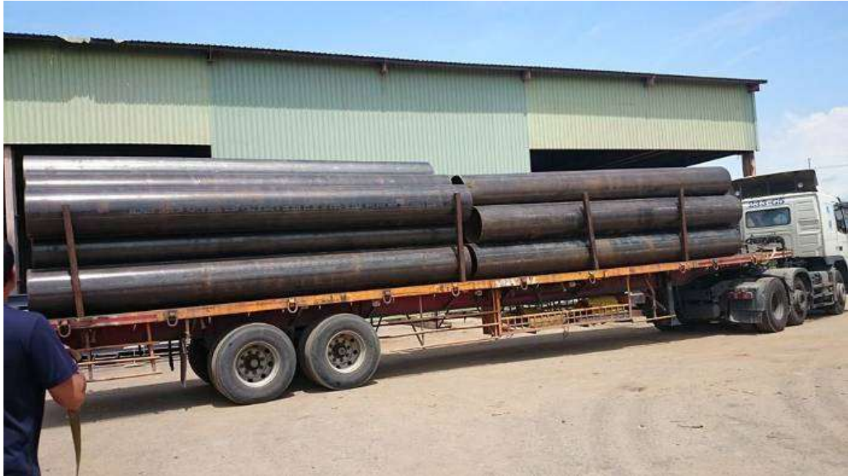
施工前 103.5.26 批號 SIN2211030 24" A53 B 6M/支 PIPE 噴砂廠噴砂準備
