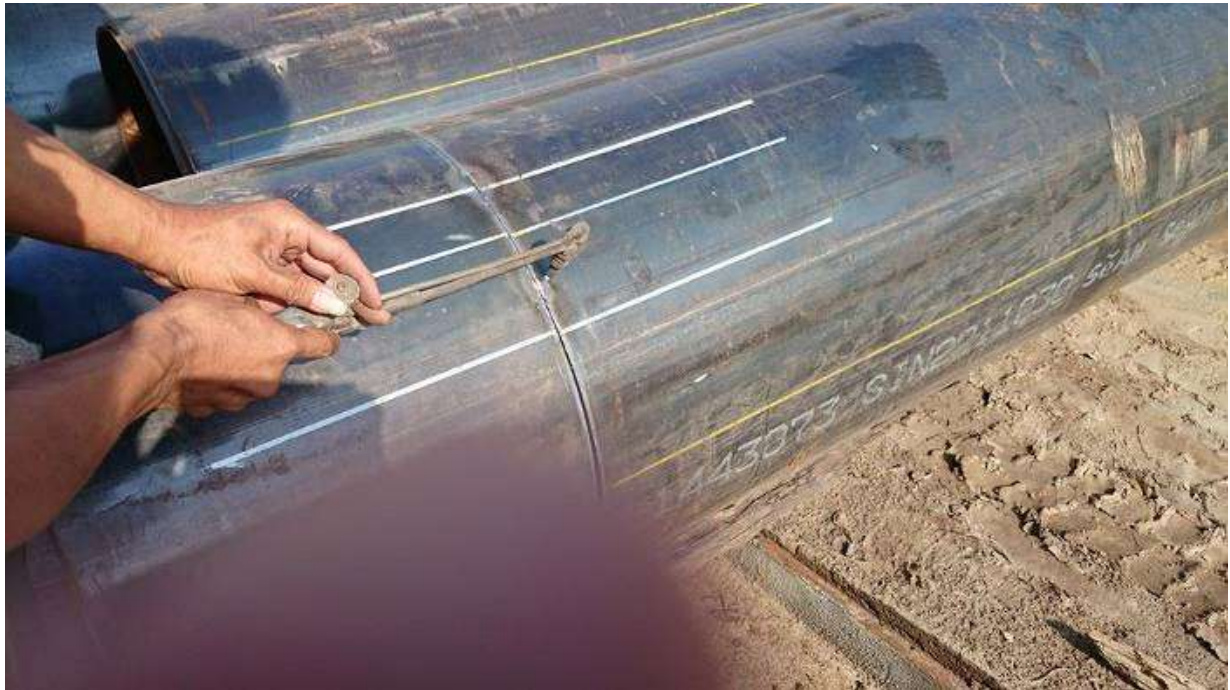
取樣中 103.5.27 批號 SIN2211030 24" A53 B PIPE
