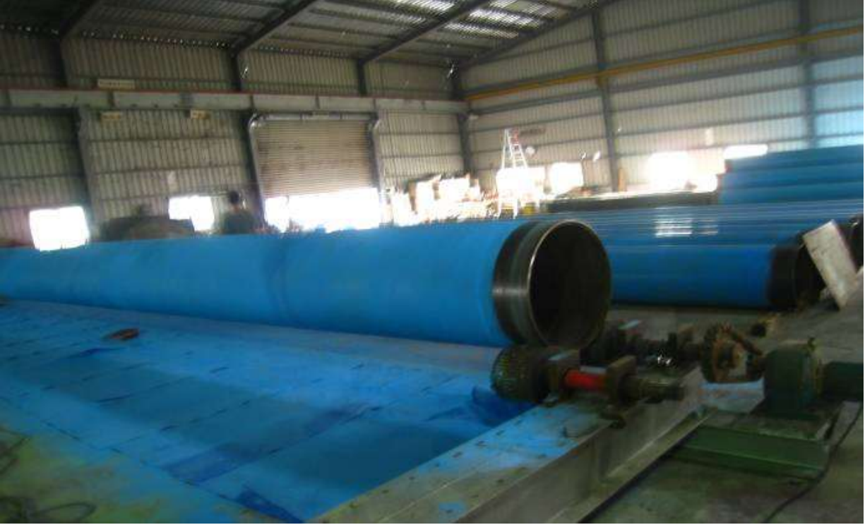
施工中 103.6.14 - 24" 管 PE 包覆
