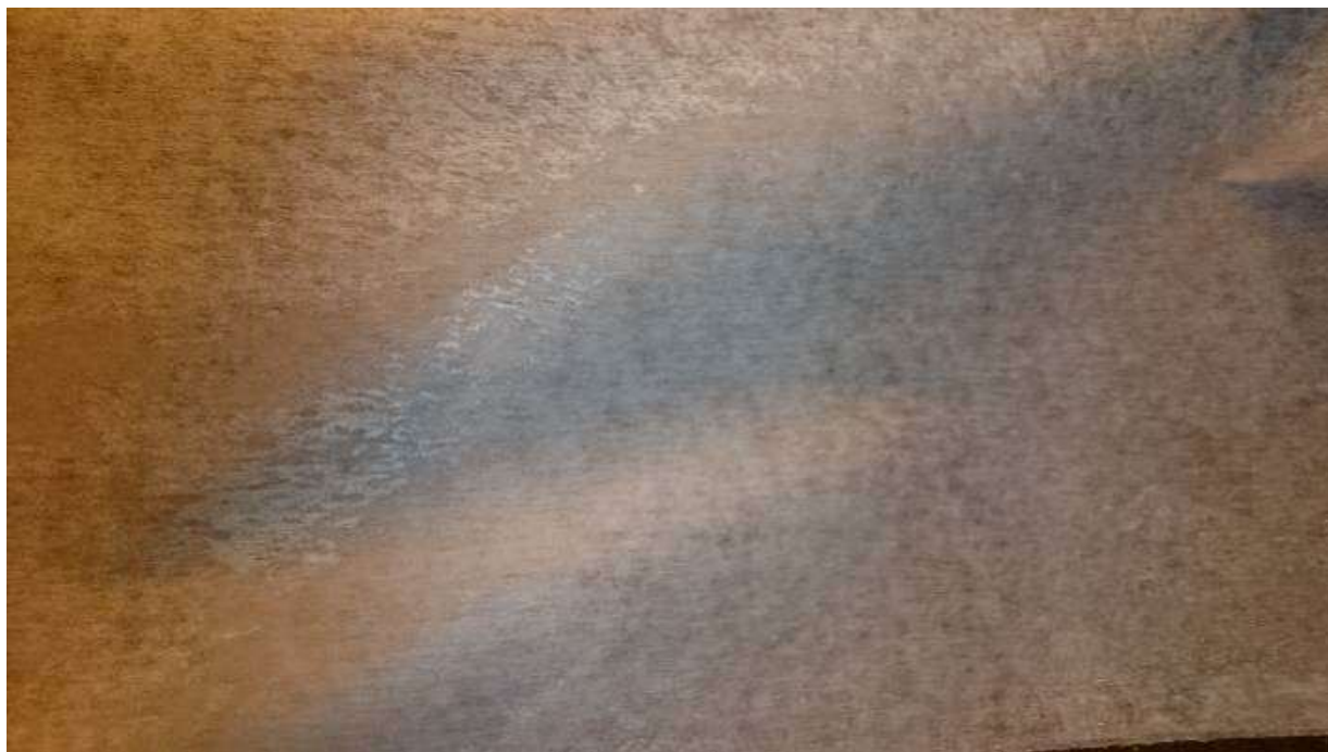
103.8.16 施工中-管路系統沖洗與清潔-不織布過濾檢驗(無雜質)
