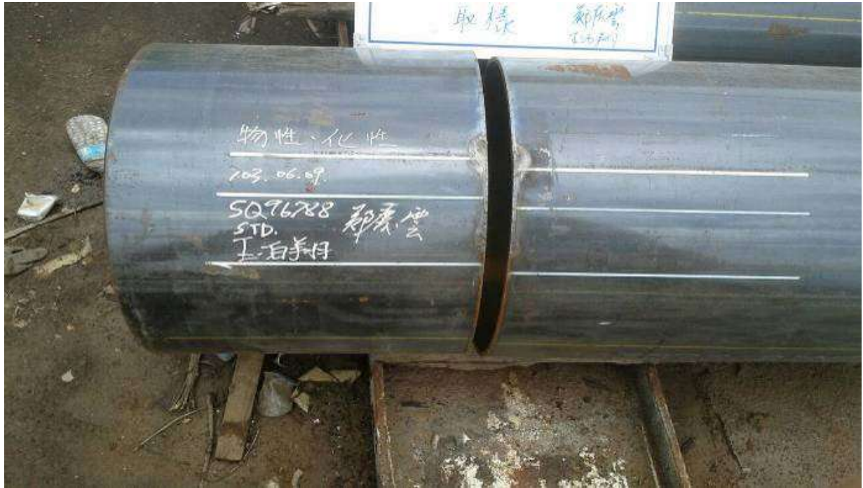
施工前 103.6.9 -24" A53 B PIPE 會同取樣
