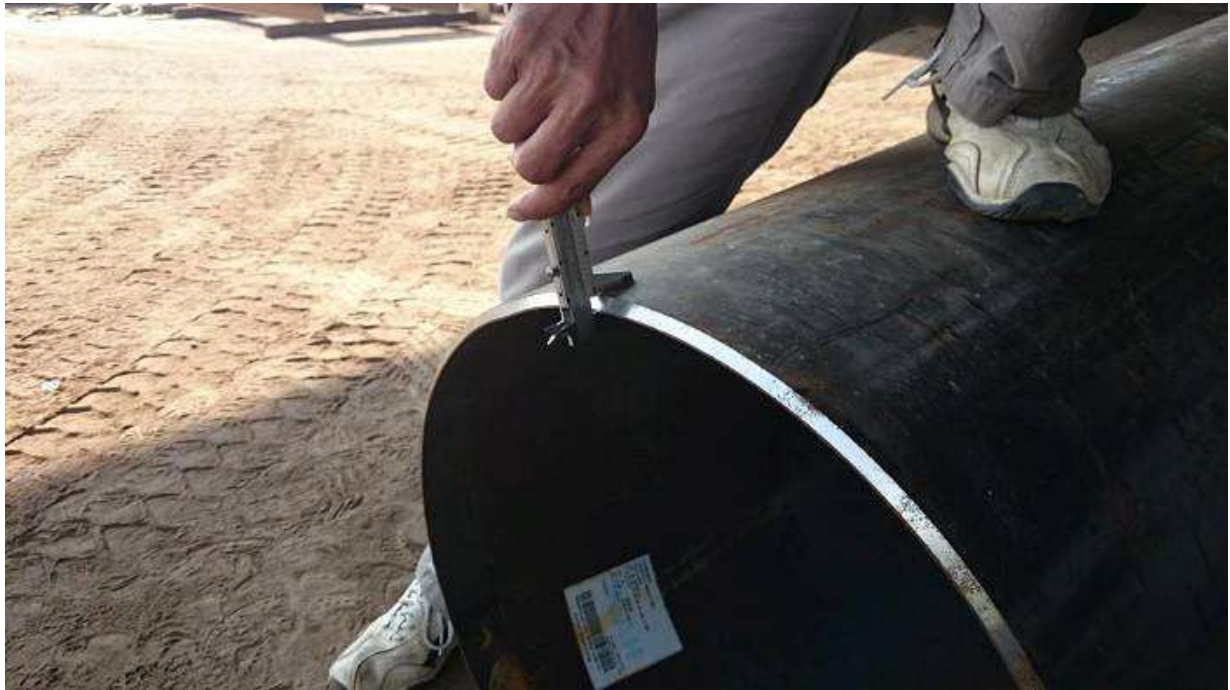
施工前 103.5.27 24" A53 B PIPE 厚度自主檢查
