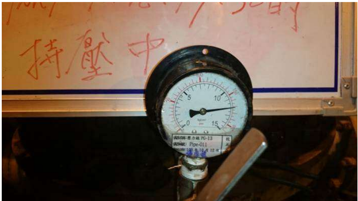
103. 8. 16 PM19:30 施工中-管線持壓\壓力表(有效期限 103. 10. 12)\持壓中-壓力 12kgf/cm 2
